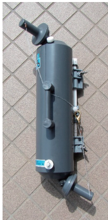
●ニスキン採水器 容器の上下に蓋があり、所定の水深で採水器を吊るすワイヤーに通した錘を船上から落とすと、ストッパーが外れて蓋が閉まり、採水ができる。
