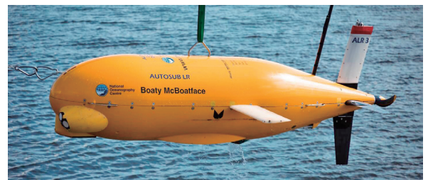
●ETI-MMVで使用されたAUV (ALR) 空中重量600~1200kg、長さ3.7m、航続距離1000km。使用するセンサーや操作の種類にもよるが、3か月の配備が可能。 出典：National Ocean Center HP
