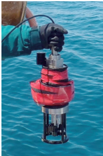
●多項目水質センサー 水質調査に必要な水温、pH、溶存酸素、塩分など、多数の項目を1台で測定できる。
