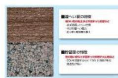
CO<sub>2</sub>を海底下の地中に封じ込めるためには、貯留層とその上部に遮へい層が存在する地質構造が必要です。遮へい層は、貯留層に圧入したCO<sub>2</sub>が貯留層から漏れないよう遮へいしています。
