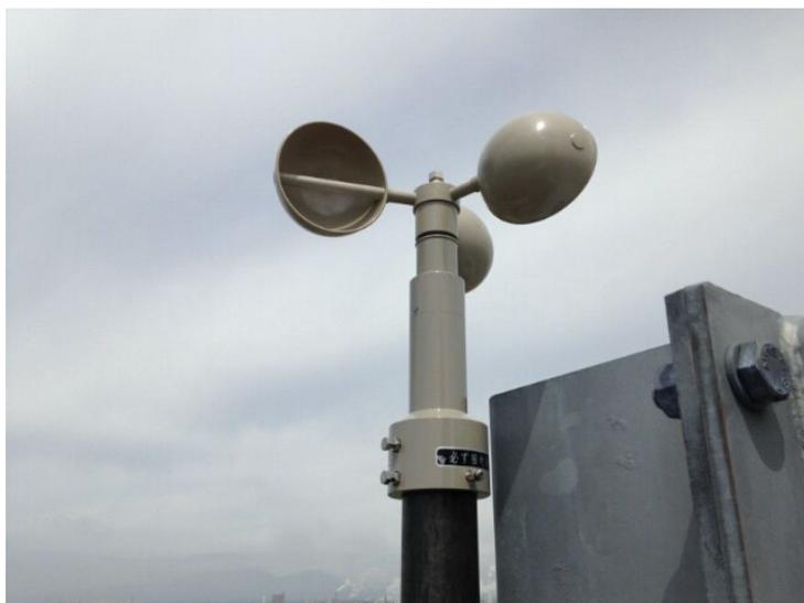
図 4.1-17 坑口装置保持鉄塔に設置した風速計
