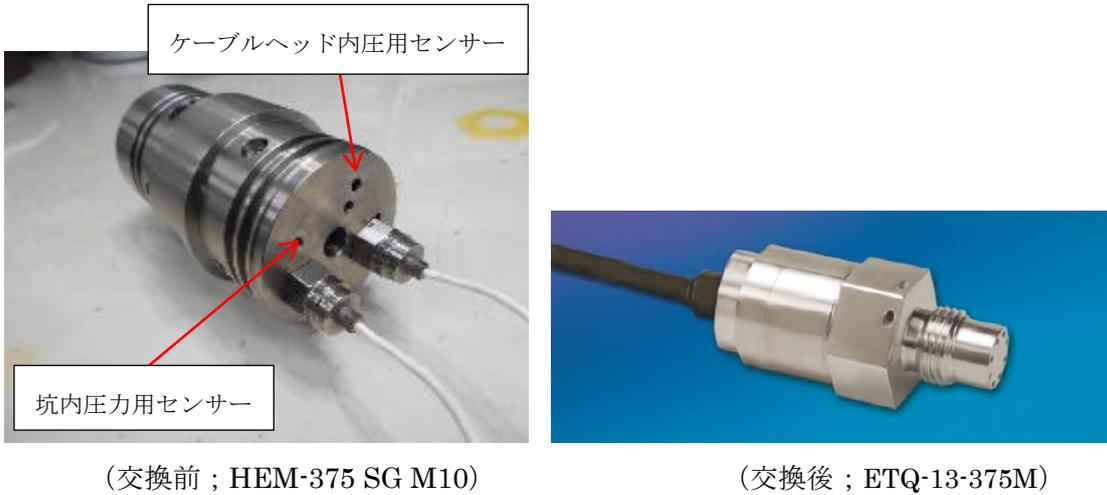
図 4.1-7 シリコン半導体圧力センサー
