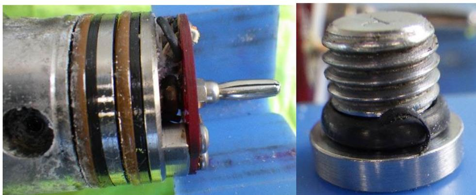
図 4.1-26 窒素ガス注入プラグ O リングの損傷
