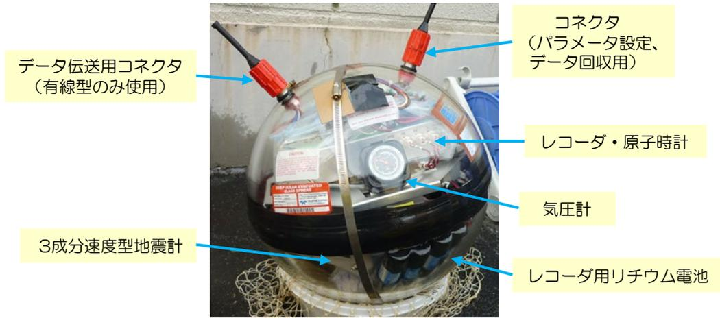
図 4.4-2 耐圧ガラス内部の様子
