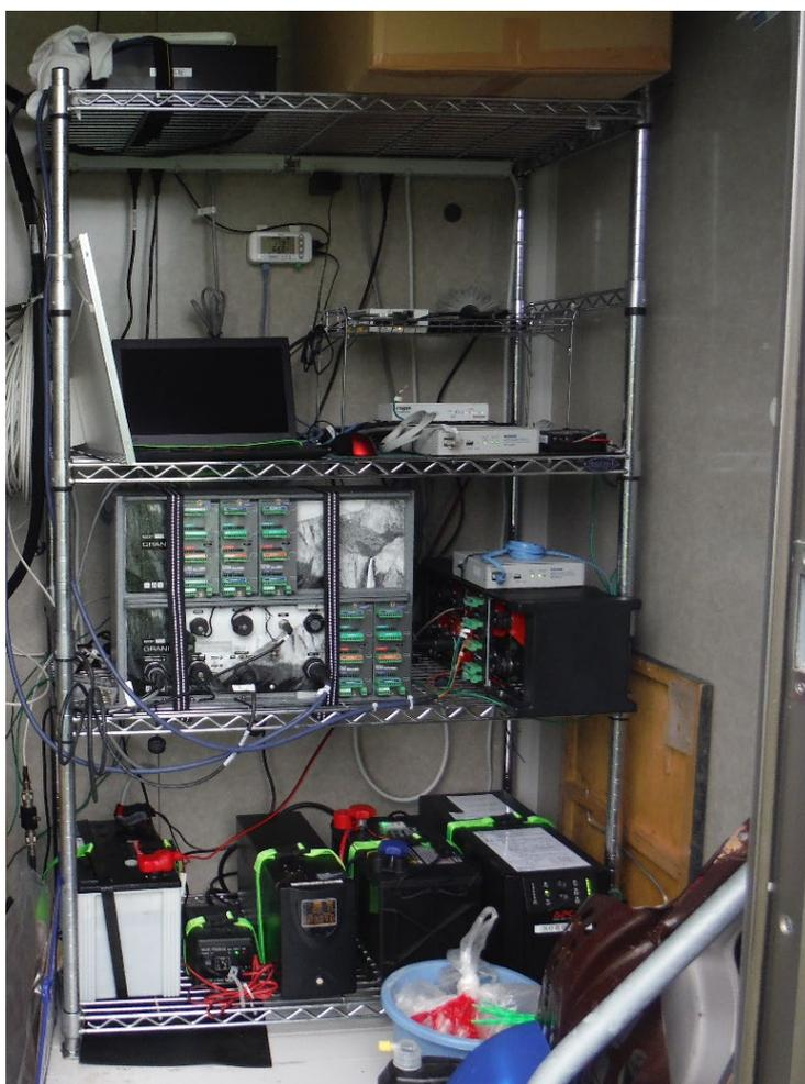
図 4.2-5 観測建屋に設置していたデータ収録関連機器
