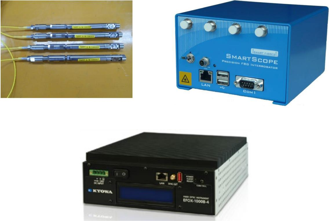
図 4.1-6 FBG センサー（左上）と FBG 地上機（左上：従来機、下：新機種）
