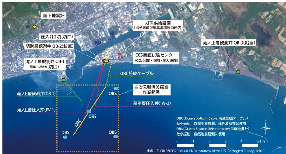
※本実証試験を通じた微小振動観測システムの最適化検討の結果、陸上設置地震計と海底地震（OBS）の運用を停止しても微小振動観測が可能であることが確認されたため、2021年度に両システムの運用を停止し撤去しました。現在は、観測井と常設型OBCを用いてモニタリングを継続しています。
