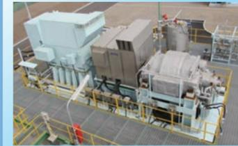
CO<sub>2</sub>含有ガスを CO<sub>2</sub>吸収塔の運転圧力まで昇圧
