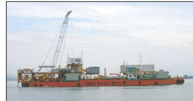
ケーブル敷設作業台船「あわじ」長さ60m、幅23m
