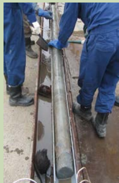
調査井から取り出した地質サンプルの一部
