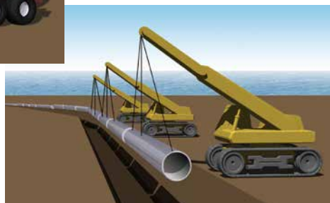
パイプライン敷設方法
