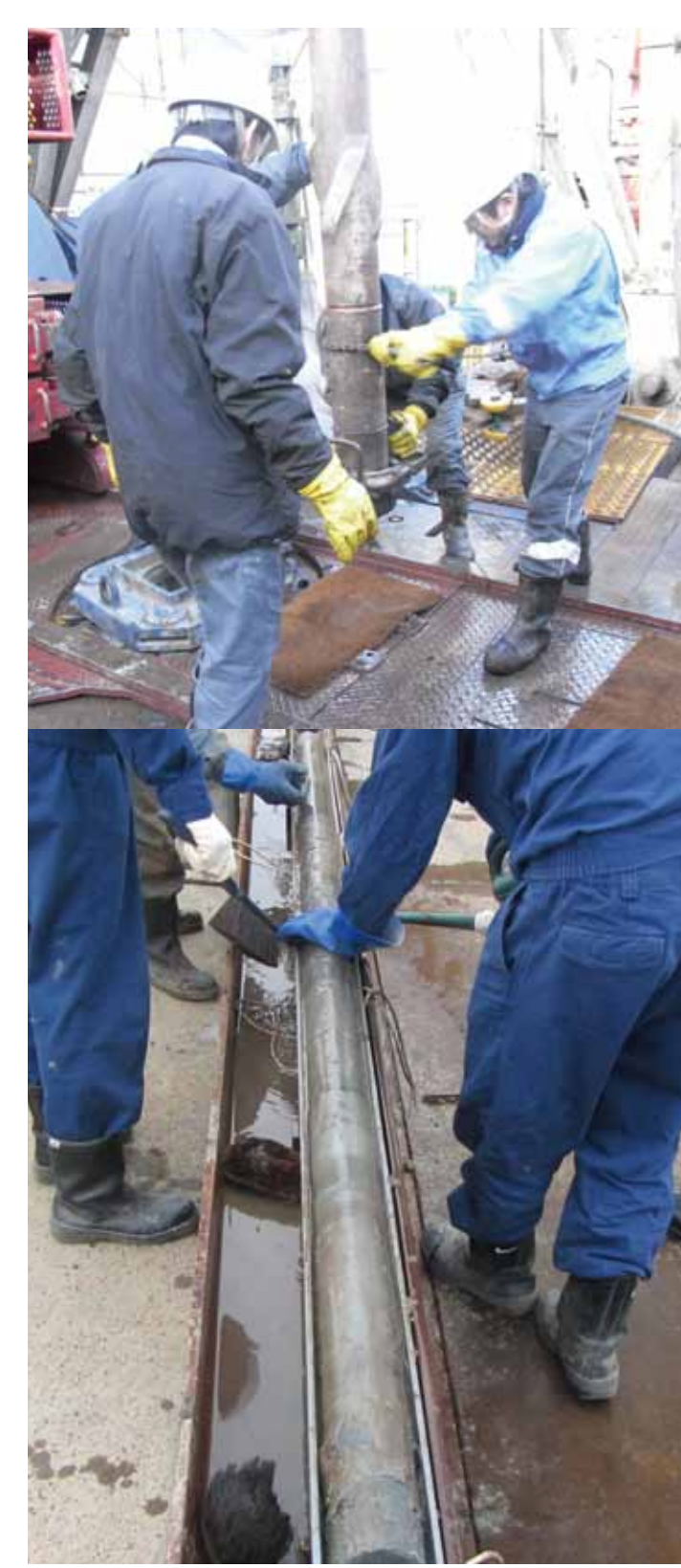
調査井掘削の様子(上)と岩石サンプル(下)
